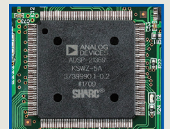
Digitaler UKW-Demodulator (DSP) Chip mit Gleitkomma-Architektur
