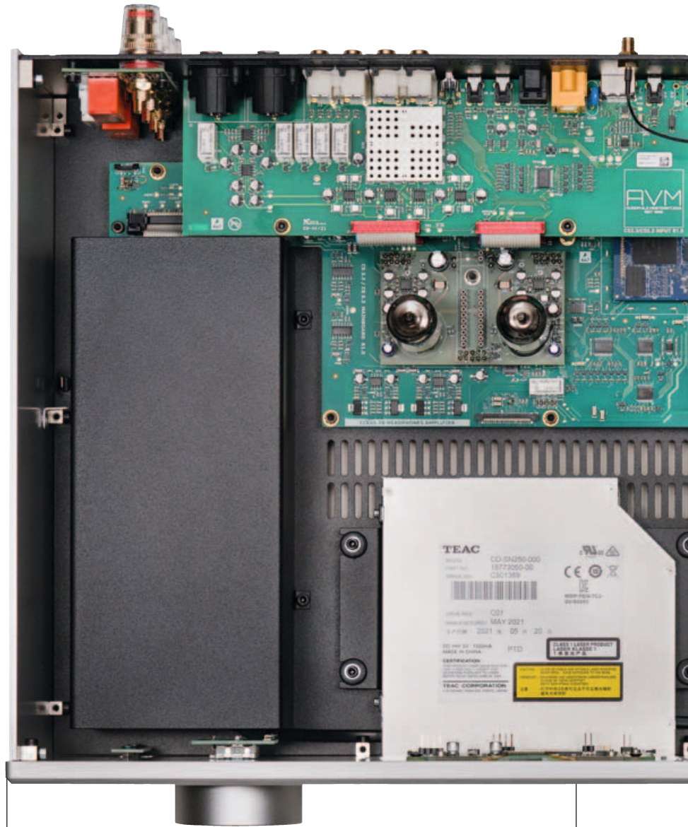
FEINER AUFBAU: Der schwarze Kasten links beherbergt die Class-D-Endstufen, rechts daneben ist die Röhrenvorstufe gut zu erkennen. Auf der blauen Platine rechts oberhalb der Vorstufe sitzt die X-Stream-Engine.
