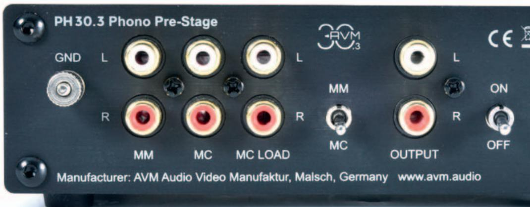
Alles im Großformat. AVM mag keine Kleinklaviersysteme – die Eingangslast wird über „MC Load“ per Chinch-Widerständen zugesteckt. Natürlich sind auch MM-Systeme erlaubt.
